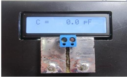
Gambar 17. LC meter siap mengukur
