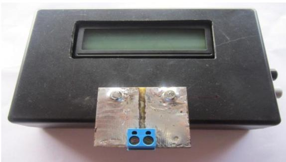
Gambar 13. LC meter lengkap dengan plate penghubung
