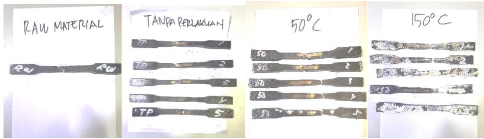
Gambar 6. Hasil uji spesimen tarik
