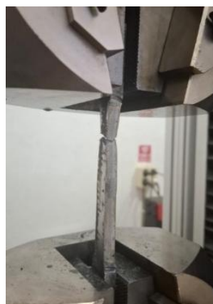
Gambar 5. Spesimen uji putus
