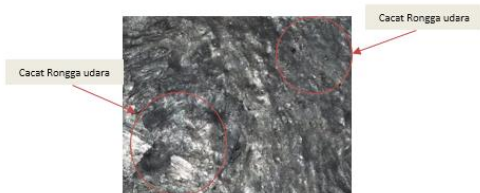
Gambar 3 Cacat hasil coran spacer velg dengan temperatur 660°C
