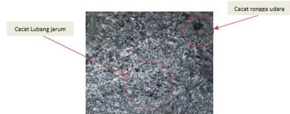
Gambar 5 Cacat hasil coran spacer velg dengan temperatur 740°C
