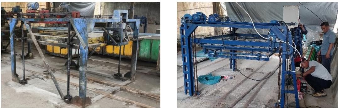
Gambar 1. Mesin Tipe Sumbu X (kiri) dan Tipe Sumbu X-Y (kanan)
