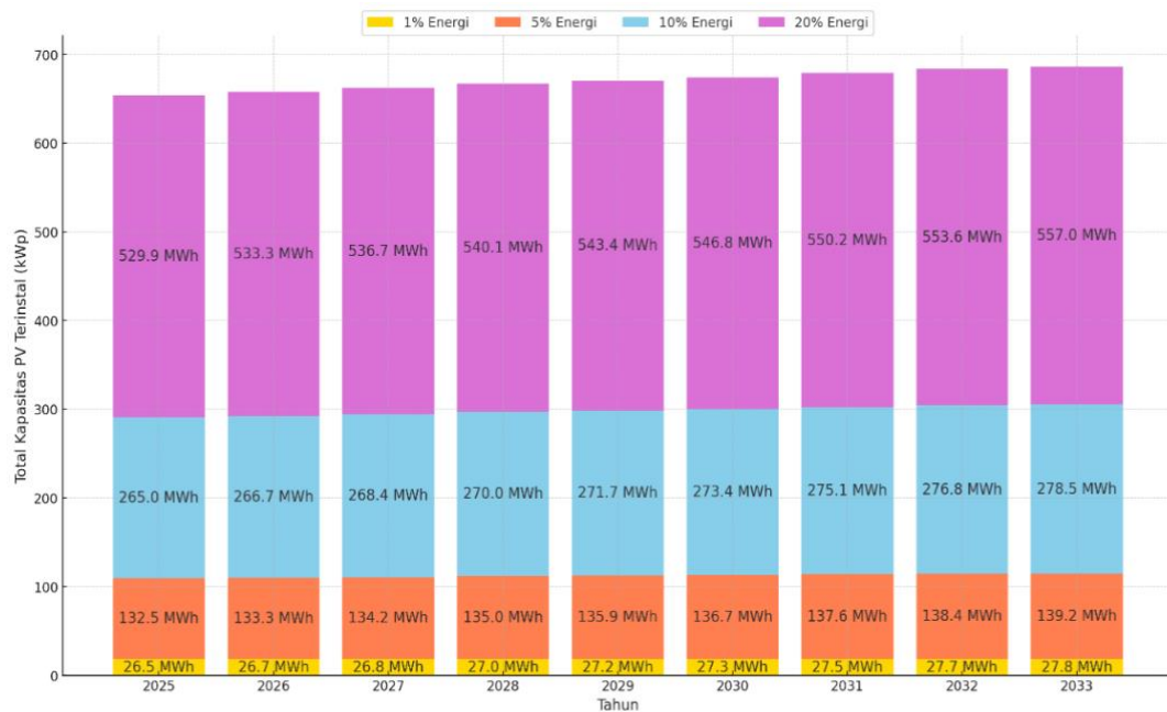
Gambar 5. Kebutuhan Energi untuk Air Bersih (MWh/tahun) dan Kapasitas PV Terinstal (kWp)
