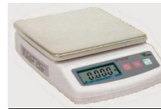
Gambar 4. Timbangan uji berat sebelum dan sesudah terkorosi
