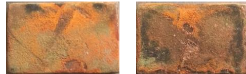
Gambar 7. Permukaan sampel setelah direndam dalam (a). air tawar dan (b). air laut
