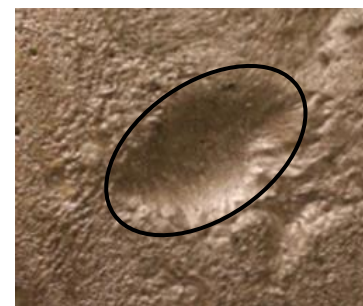
Gambar 6. Cacat rongga udara. 740°C
