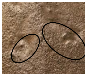
Gambar 5. Cacat rongga udara. 700°C
