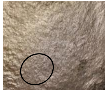
Gambar 4. Cacat rongga udara. 660°C
