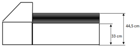
Gambar tinggi bak mobil L300 sebelum dan sesudah dimodif
