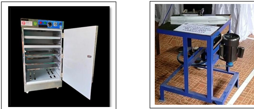
Gambar 2. Oven Pengering Sale (kiri) dan Alat Pengiris Keripik Pisang (kanan)
