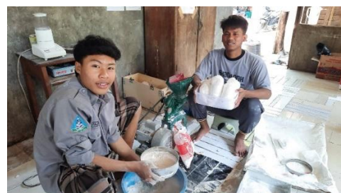
Gambar 7. Penggilingan chip singkong menjadi tepung mocaf
