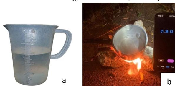
Gambar 3. Uji pembakaran briket: (a) Air dengan ukuran 300 ml; (b) Briket 2 buah yang dapat mendidihkan air dalam waktu 1,38 detik
