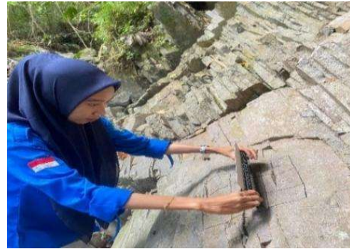
Gambar 2. Pengukuran JRC Menggunakan Alat Sisir Barton
