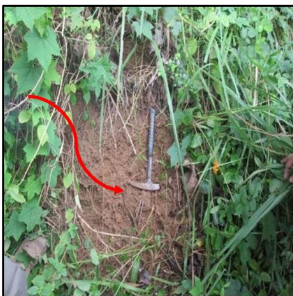
Gambar 11. Foto tanah residu hasil pelapukan dari tufa yang terdapat di lokasi penelitian. Tanah jenis ini rentan mengalami longsor karena termasuk tanah gembur
