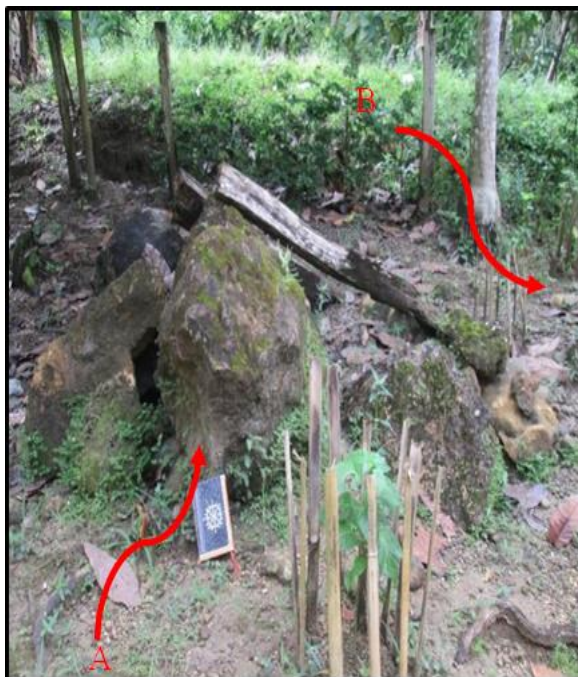
Gambar 10. Foto batugamping lapuk sedang (A) dan tanah residu dari batugamping (B) yang terdapat didekat badan jalan (Gambar 8)
