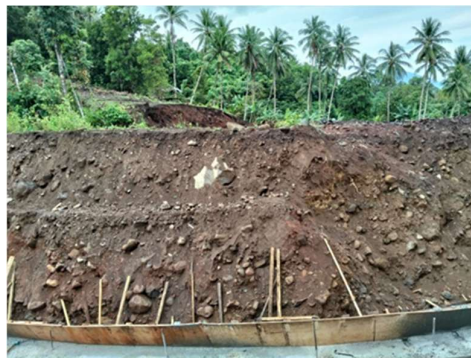
Gambar 3. Parit Uji Endapan Banjir Bandang bagian hilir
