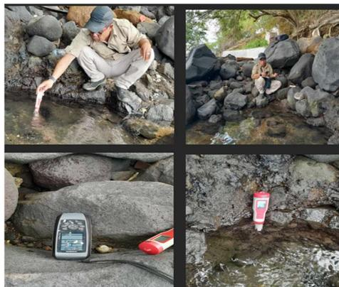
**Gambar 3.** Pengambilan Data Koordinat dan Pengukuran Suhu Air Panas Pada Titik 2
