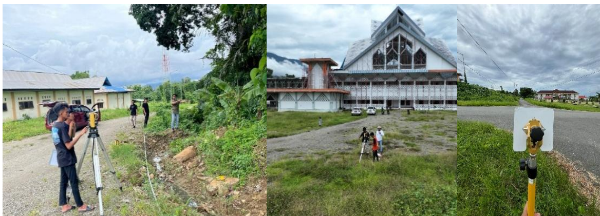
Gambar 1. Proses Pengukuran Topografi Menggunakan Total Station
