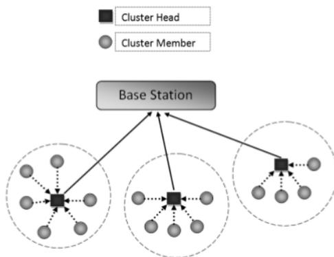
Gambar 1. Model Cluster pada Jaringan Sensor Nirkabel
