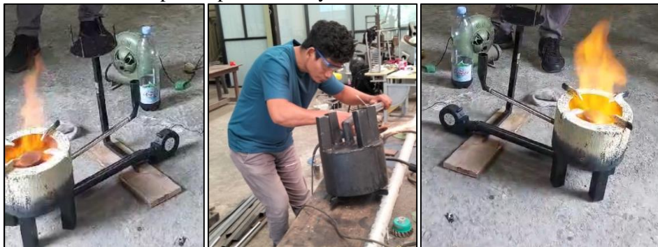
Gambar 2. Kompor Alternatif berbahan bakar minyak jelantah
