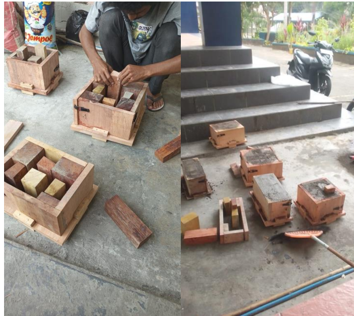
Gambar 3. Proses pencetakan Batako Interlock
