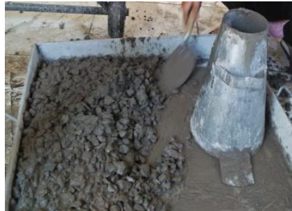
Gambar 4. Pengujian Slump Sumber : Hasil Pengujian Slump
