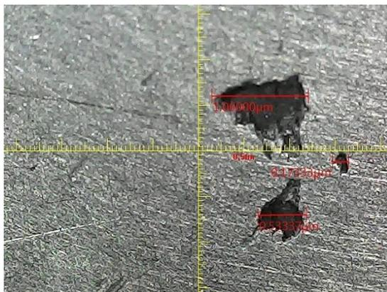
Gambar 2. Cacat porositas yang terjadi pada variasi suhu penuangan 650°C
