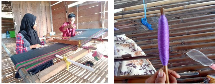
Gambar 3. Pembuatan gulungan benang dan dihani dalam sebuah lalatan
