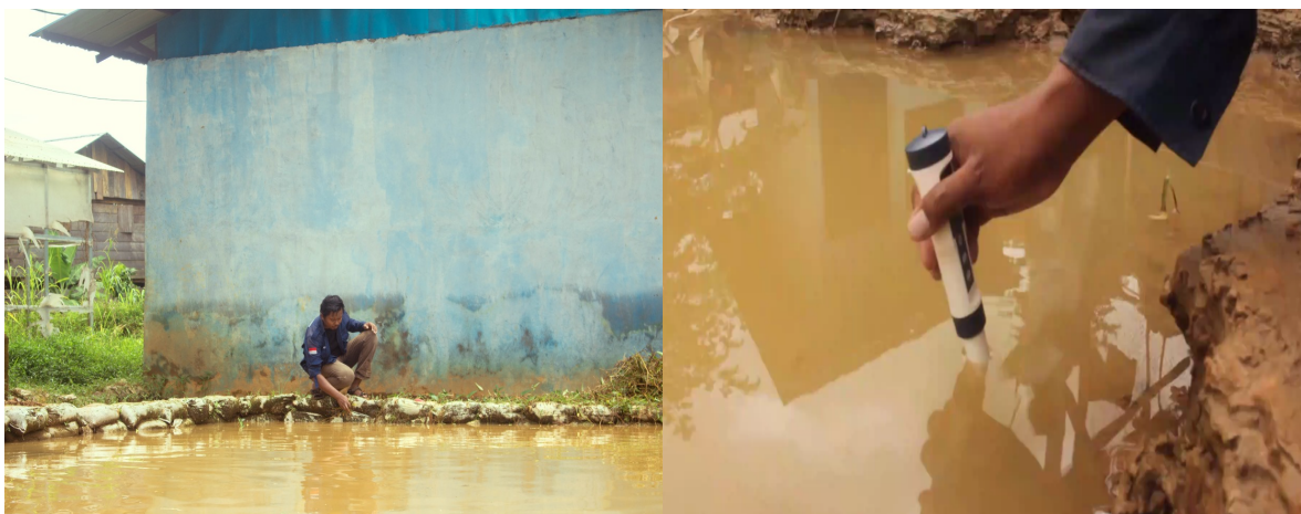
Gambar 4. Demonstrasi pengujian kualitas air limbah tambang dengan pH meter
