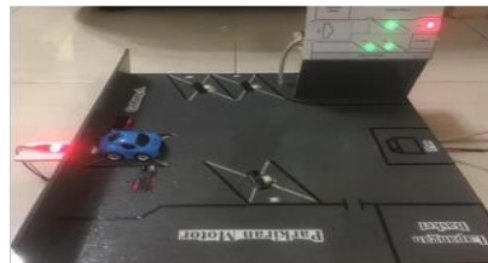
Gambar 8. Pengujian Objek Menggunakan Sensor Infrared Proximity Slot B1
