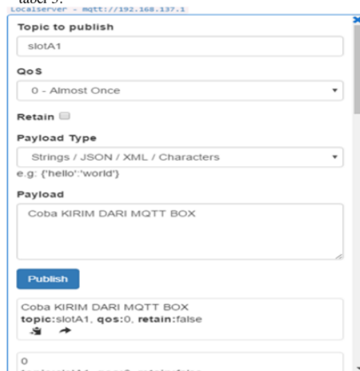
Gambar 5. Pengiriman Data pada MQTT Box
