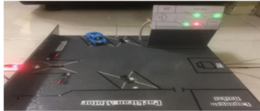
Gambar 7. Pengujian Objek Di Atas Sensor Slot A1 Tabel 5 Hasil Pengujian Sensor Jarak IR SHARP GP2Y0A21.
