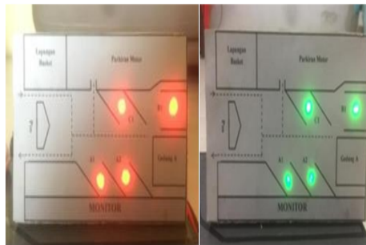
Gambar 11. Pengujian Slot parkir penuh dan kosong
