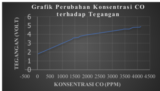
Gambar 15. Grafik Hubungan Konsentrasi Gas CO terhadap Tegangan (Volt)
