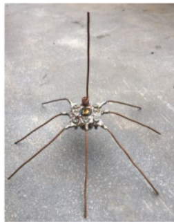
Gambar 6. Hasil Pembuatan Antena Ground Plane
