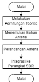
Gambar 2. Flowchart Pembuatan Antena Ground Plane
