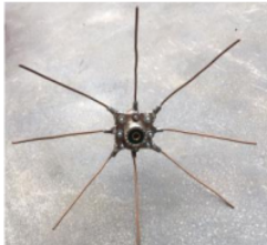
Gambar 7. Hasil Pembuatan Antena Ground Plane
