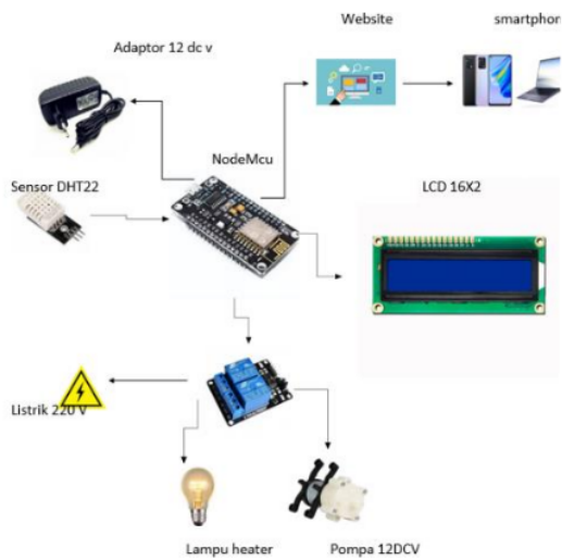
Gambar 6. Rangkaian Monitoring Dan Controlling Suhu Dan Kelembaban Pada Kumbung
