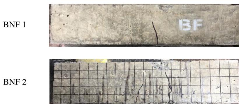
Gambar 13. Pola Retak Balok BNF
