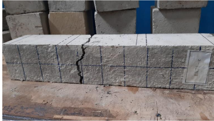
Gambar 5. Pola Retak Balok
