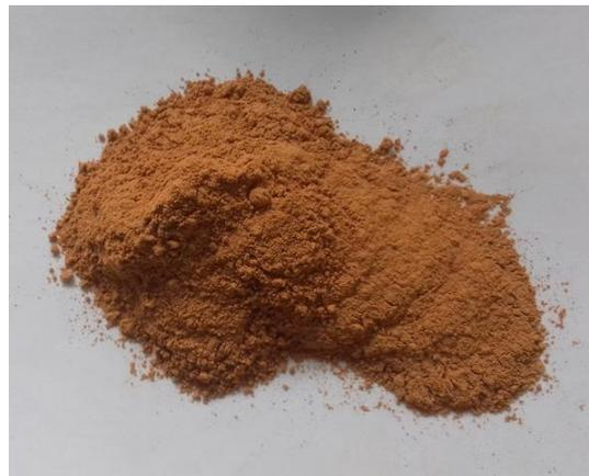
Gambar 3. Lempung untuk Tanah Dasar
