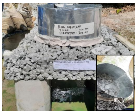
Gambar 3. Proses Pengujian Infiltrasi Beton Berpori
