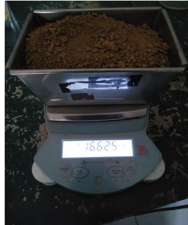
Gambar 6. Penimbangan Sampel Tanah Untuk Memeriksa Kadar Air
