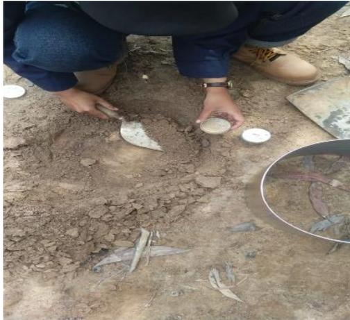
Gambar 5. Proses Pengambilan Sampel Tanah
