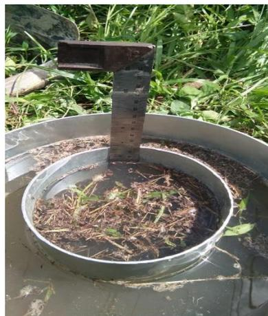
Gambar 4. Mengukur Penurunan Tinggi Permukaan Air ( $\Delta H$ )
