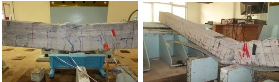
a. Kegagalan tekan balok BN b. Kegagalan tekan balok BF0
