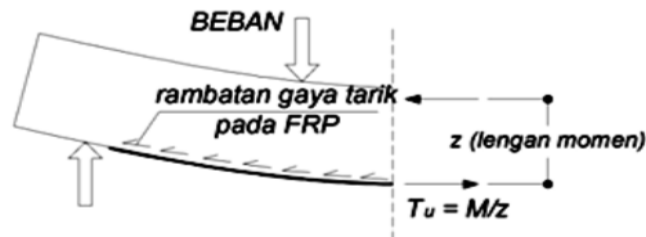
Gambar 3. Model aksi-reaksi tegangan GFRP-S setelah pembebanan
