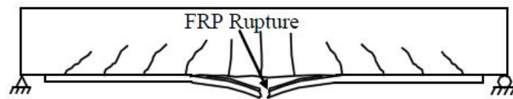
a. Putusnya FRP dan hancurnya beton pada sisi Tarik
