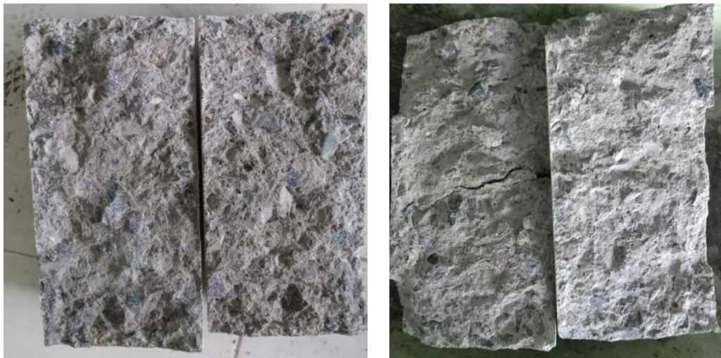
Gambar 4. Dokumentasi Pengujian Tarik Belah Pada Benda Uji
